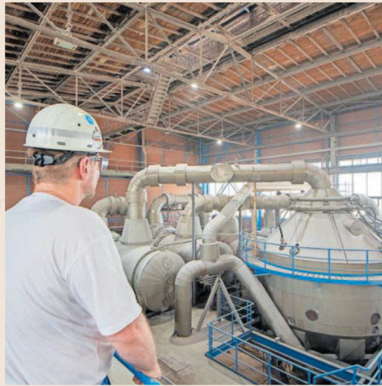
Un empleado supervisa una planta evaporadora que extrae cloruro potásico de las sales extraídas del subsuelo, en Ziehlitz (Alemania). GETTY IMAGES
