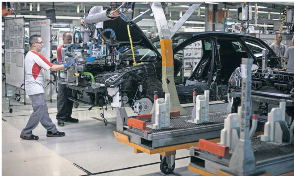
Cadena de montaje de los frontales del Seat León en la fábrica de Martorell. / ALBERT GARCIA
